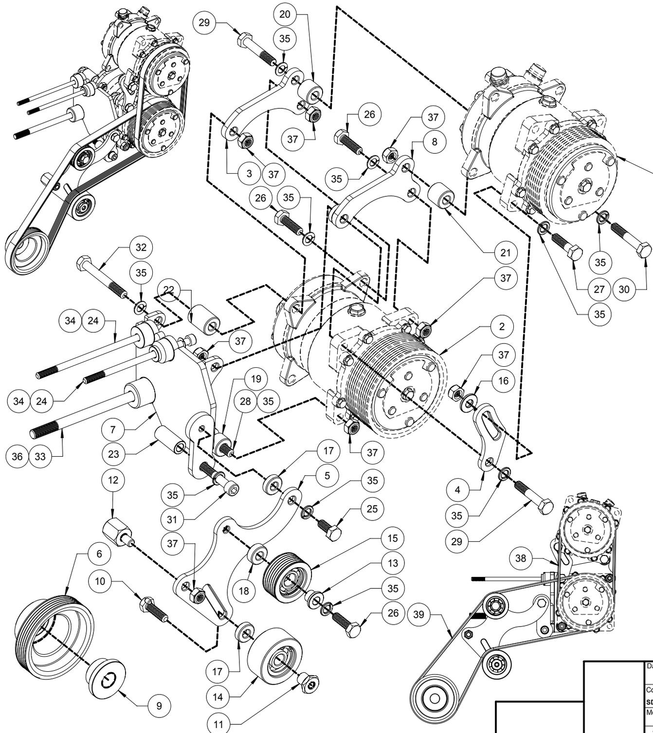
Particolare fissaggio Secondo Compressore
